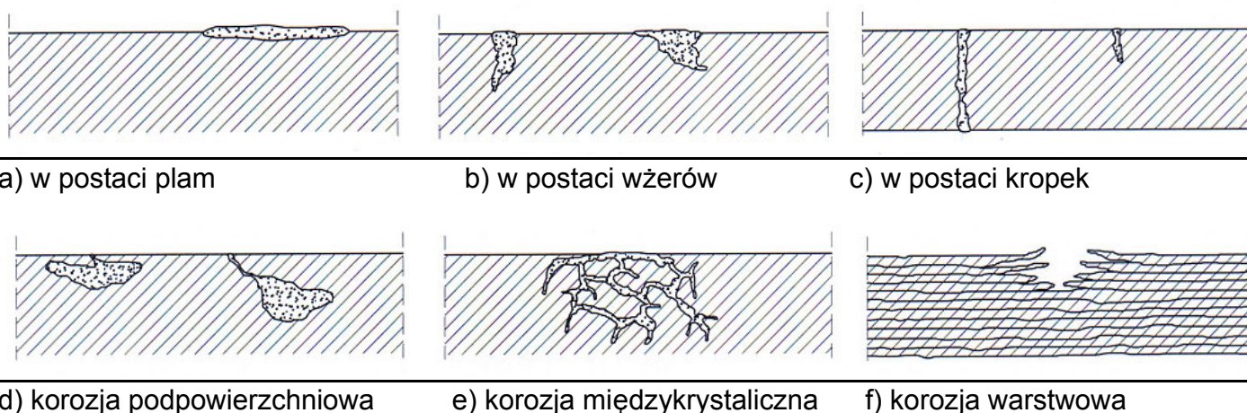
Rys.4. Rodzaje korozji lokalnej [1]
