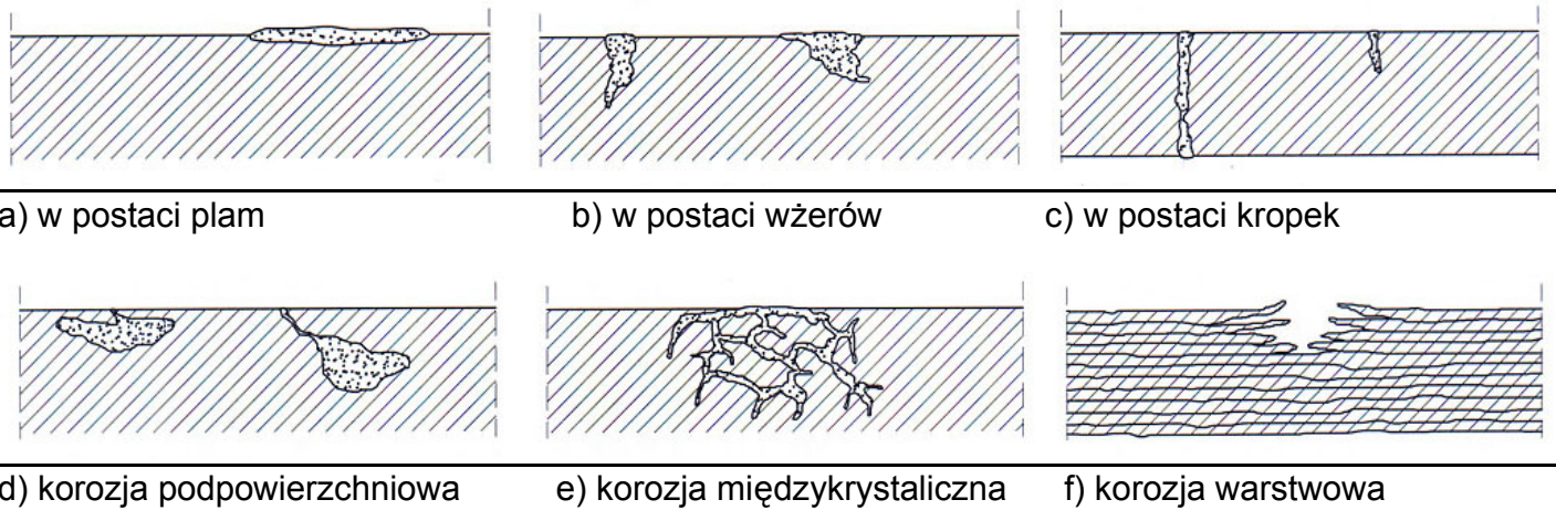
Rys.4. Rodzaje korozji lokalnej [1]
