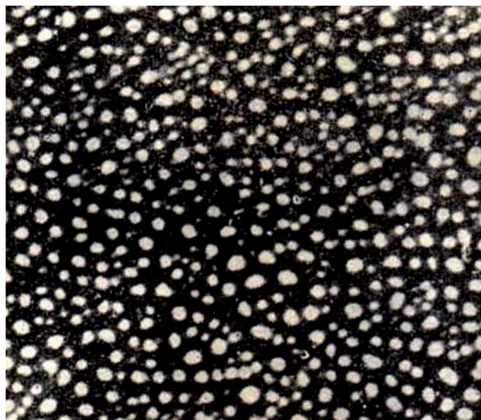
Zdj. 1. Struktura porów w powłoce tlenkowej (zdjęcia wykonane metodą repliki pod mikroskopem elektronowym, pow. 35 000 x)
