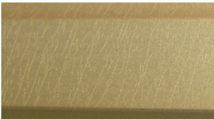
Zdj.2 Przykładowe spękania warstwy anodowej
